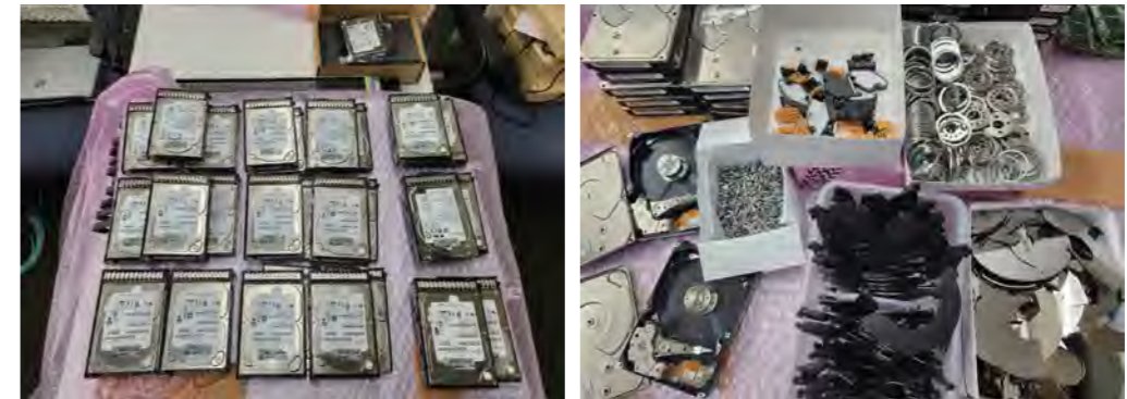
HDD等を受け取った状態(左)と、プラッタ破壊後(右)の様子。HDDは財団で分解し、プラッタ部分を破壊した上で廃棄処分を行います。
